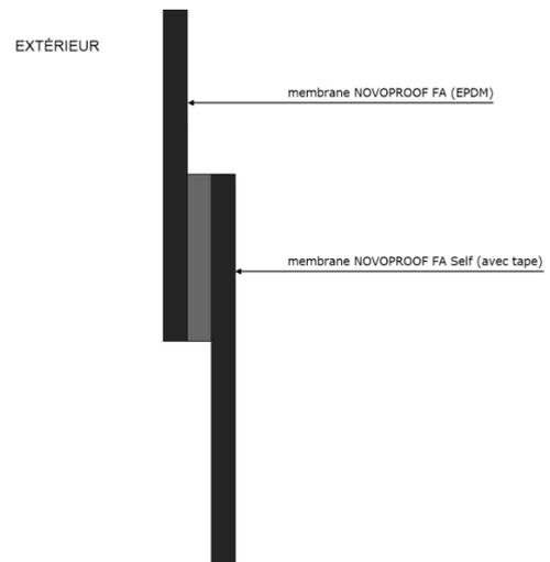
**FIGURE 13 : collage raccords avec Self**
