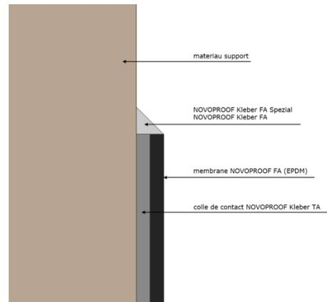
Figure 7 : collage sur support avec Kleber TA
