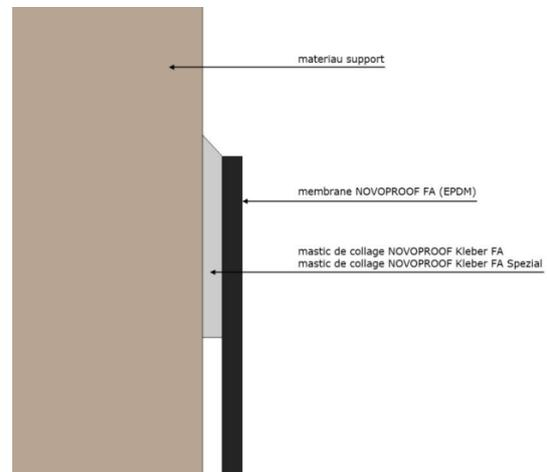
FIGURE 8 : collage sur support avec Kleber FA et Kleber FA Spezial
