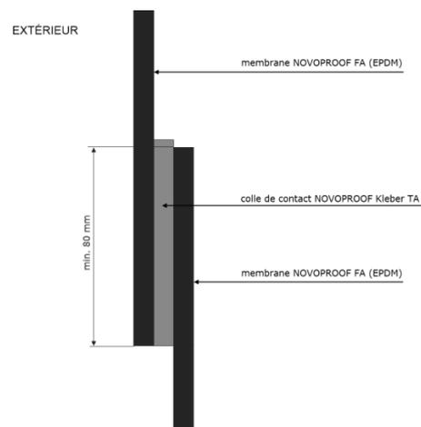
**FIGURE 11 : collage raccords avec Kleber TA**
